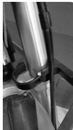
**2.** Comience girando el manillar hacia la derecha para dejar espacio entre barra y chasis. Monte la brida izquierda de SLING FAST, haciéndola pasar alrededor de la barra izquierda de la suspensión, dejando el cableado de freno delantero y cuenta km en el lado interno del brazo de fijación de SLING FAST.
