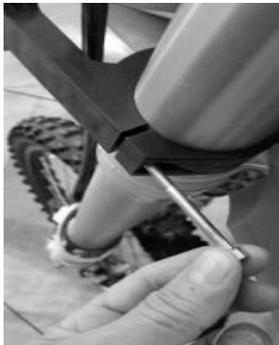
**5.** Pase el tornillo (1) por el orificio de la brida y rosquelo ligeramente con la mano en la tuerca(2) que posicione en el paso anterior. No apriete aun este tornillo hasta no tener montado el brazo derecho en la barra derecha.
