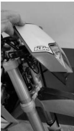
**1.** Para facilitar el montaje de SLING FAST, afloje o desmonte el frontal donde está fijado el faro.
