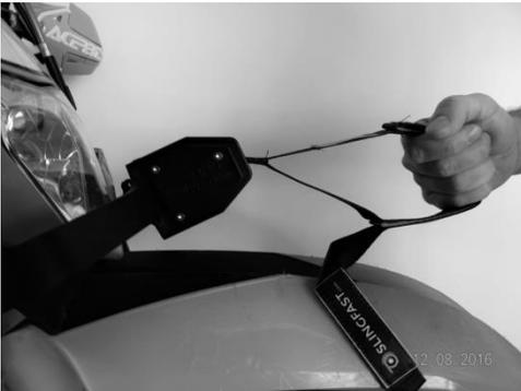
2º Una vez liberada la cinta de fijación (10), coja el maneral de tracción (9) y tire hasta extender en su totalidad la cinta de tracción (7).
