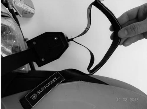
1º Una vez ha dejado de usar la cinta de tracción (7), debe volver a enrollar el maneral (9) alrededor del cabezal (6) con la cinta de fijación (10).
