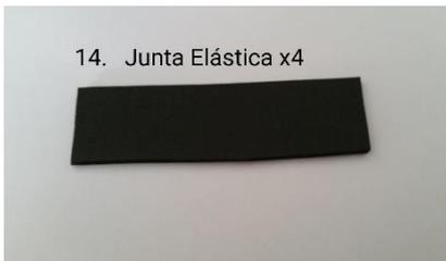
Si en esta zona se observa que la barra es de forma cónica, debe poner la junta elástica (14) para compensar esa conicidad. También debe poner una junta elástica (14), si sus barras son de medidas inferiores o SLING FAST no queda fijado firmemente. El montaje de este accesorio en barras con forma cónica en la zona de cojida, podría hacer que se aflojase incluso montando las juntas elásticas (14).
