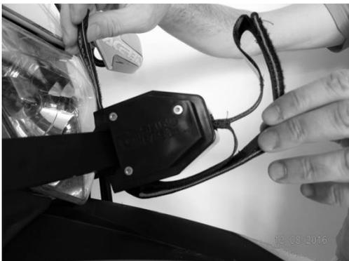
2º Pase la cinta de fijación (10) por debajo del cabezal (6) y tire ligeramente hasta que la mitad del maneral (9) llegue hasta la parte trasera de este.
